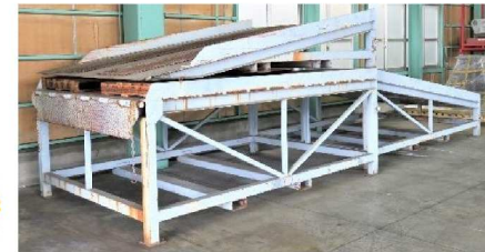
倉庫内に設置されている移動式コンテナスロープ
